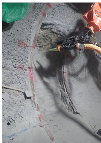
ベントナイト吹付けプラグの工学規模試験
