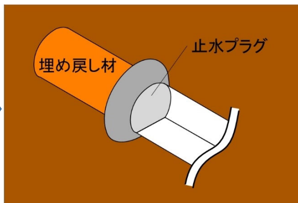
ベントナイト吹付けプラグの工学規模試験
